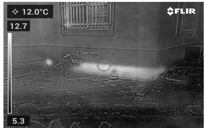
그림 8. 외단열 지면접합부의 실화상 및 열화상
